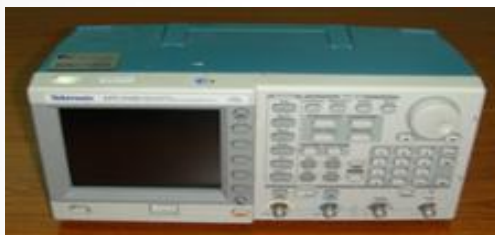
Tektronix AFG3012 Function Generator
